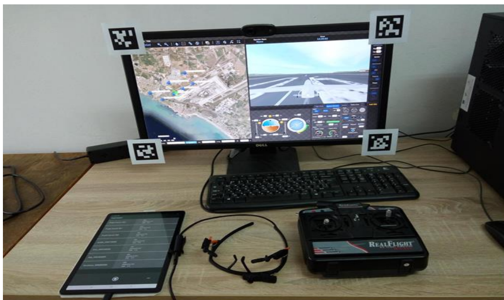
Фиг. 2. Общ вид на работното място с тренажор C-Star, мобилен окулограф Pupil Labs Core, Таблет Samsung Galaxy Tab
